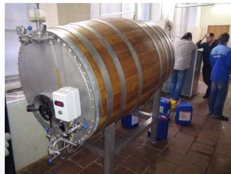
Танки для брожения-доброживания Wasamonga, установленные в ресторане «Балтика Брю»
