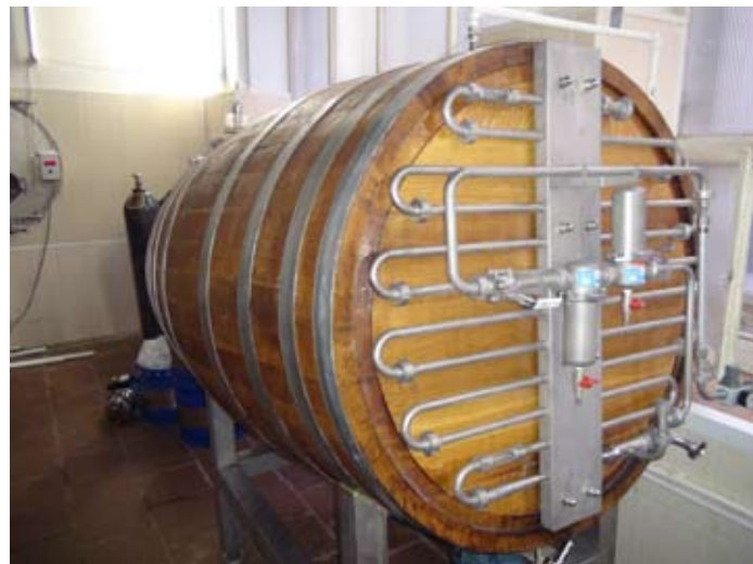
Танк для фильтрованного пива Wasamonga с карбонизатором, эксплуатируемый в ресторане «Балтика Брю»
