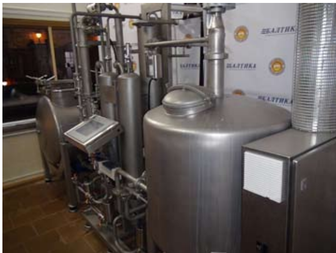
Инновационный варочный порядок Satenik, установленный в ресторане «Балтика Брю» (Санкт-Петербург)
